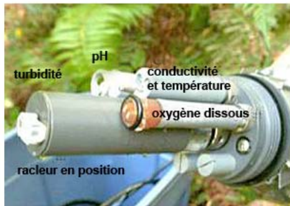
Photo 9 (à gauche). Appareil à sondes multiples équipé d'un racleur. (Source : B.C. Ministry of Environment, 2006.)
