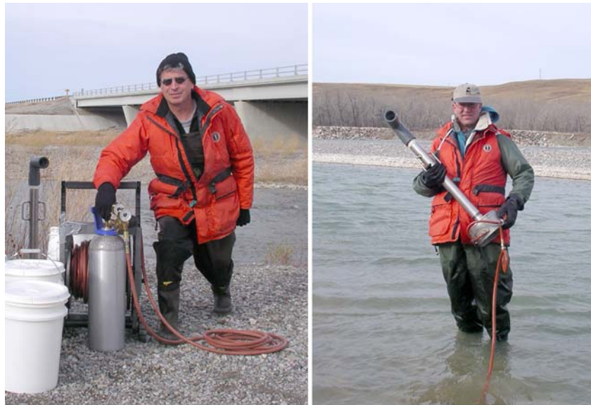
Photo 15. Échantillonneur par émulsion d'air. (Avec l'aimable permission de Darcy McDonald, Alberta Environment, et Alberta Environment (2006).)
