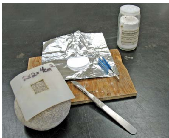
Photo 23 (gauche). Exemple de gabarit en plastique souple (Source : Alberta Environment, 2006).
