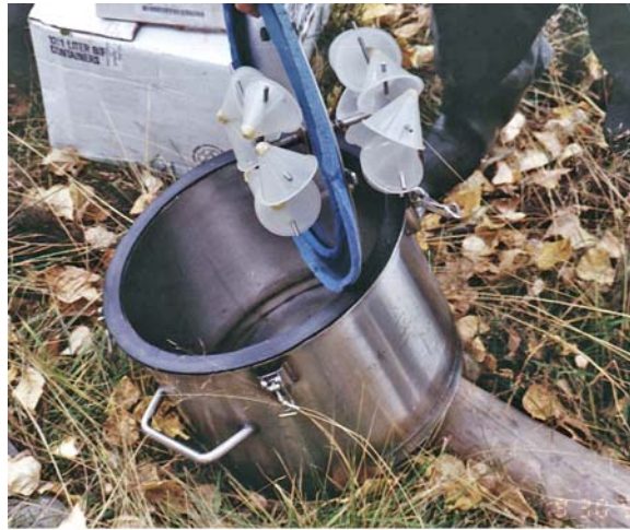
Photo 17. Cuve servant à mesurer la demande en oxygène des sédiments. (Alberta Environment, 2006a.)
