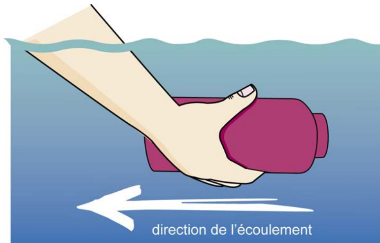
Figure 2. Technique pour prélever des échantillons instantanés manuellement. (Source : RESE-Nord, 2005.)
